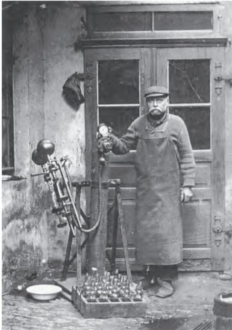
Eduard Schmidt um 1910 mit dem Abfüllgerät für die im Holzkasten befindlichen Kugelverschlussflaschen
