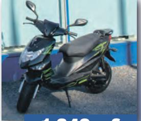
1 Zyl. Zweitakt, Kühlung: Luft, Hubraum: 49.3 ccm, Leistung bei Drehzahl: 3,1 KW, Starter: Elektro/Kick, Max. Geschwindigkeit: 25/45 km/h, Getriebe: C.V.T. Automatik, Scheibenbremse vorn, 2 Rückspiegel, 12 Zoll Räder, Trommelbremse hinten, Gepäckbrücke, Seitenständer, analoger Tacho, Tankinhalt: ca. 5,5 Liter
